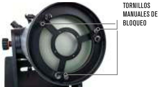
Figura 21: Para el Dob de 10", dispone de tres tornillos manuales con muelle de colimado que ajustan la inclinación del espejo primario. Los otros tres tornillos manuales bloquean en posición el espejo cuando finalicen los ajustes de inclinación.
