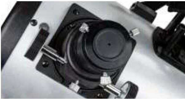
Abbildung 15: Um die Ausrichtung der Spiegel zu überprüfen, verwenden Sie die mitgelieferte Kollimationskappe mit dem Fokussierer.
