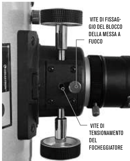
Figura 5: la vite di blocco della messa a fuoco blocca il focheggiatore in posizione una volta raggiunta la messa a fuoco. La vite di tensionamento della messa a fuoco regola la tensione delle manopole di messa a fuoco.
