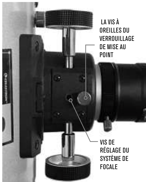
Figure 5: La vis à oreilles du verrouillage de mise au point verrouille le système de focale une fois la mise au point effectuée. La vis de réglage de la tension de mise au point règle la tension des boutons de mise au point.
