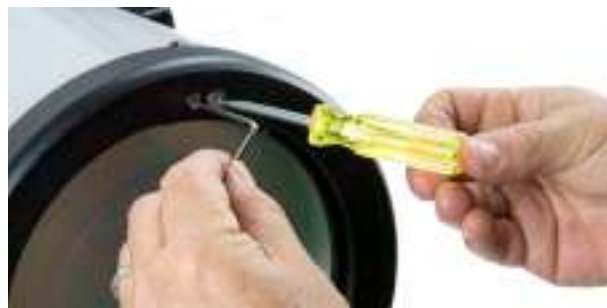
Figure 20: Pour le Dob de 8", trois jeux de vis de réglage dans la cellule du miroir permettent de régler l'inclinaison du miroir principal. Desserrez une vis de la paire et serrez l'autre pour régler l'inclinaison.
