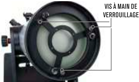
Figure 21: Pour le Dob de 10", il se trouve trois vis de serrage à ressort qui règlent l'inclinaison du miroir principal. Les trois autres vis à main verrouillent le miroir en place une fois les réglages d'inclinaison terminés.
