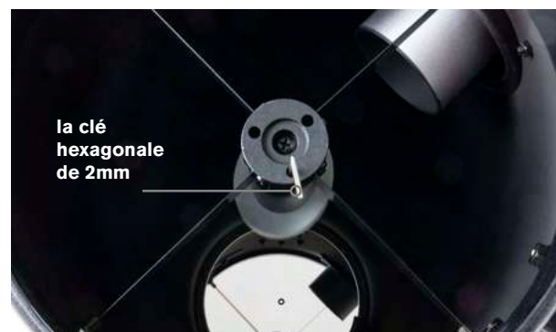
Figure 18: Les trois vis à tête creuse de réglage du miroir secondaire permettent de régler l'inclinaison du miroir secondaire.
