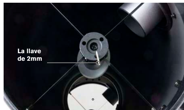
Figura 18: Los tres tornillos de cabezal hexagonal del soporte del espejo secundario ajustan la inclinación del espejo secundario.
