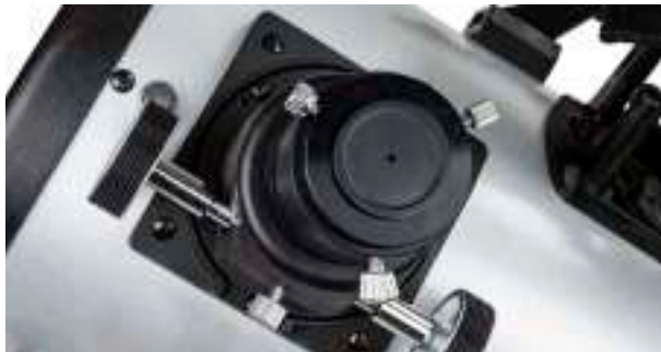
Figure 15: Pour vérifier l'alignement des miroirs, utilisez le capuchon de collimation inclus dans le système de focalisation.
