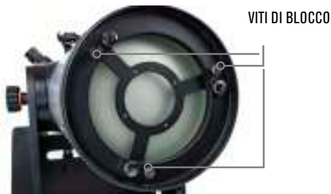
Figura 21: per il dobson 10", sono presenti tre set di viti di collimazione caricate a molla che regolano l'inclinazione dello specchio primario. Le altre tre viti di fissaggio bloccano lo specchio in posizione una volta ultimate le regolazioni all'inclinazione.
